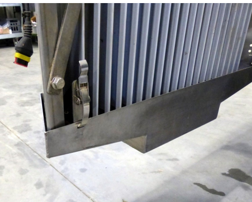
Abb. 4: Kollektorrahmen aus Edelstahl mit Kunststofflamellen, Sumpf und Schnellverschlüssen für das Abklappen des Sumpfes.
